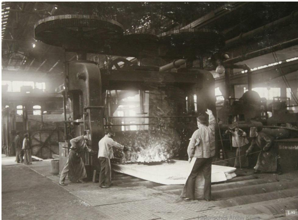
Quelle: Das Walzen einer Panzerplatte im Essener Panzerplattenwalzwerk der Firma Krupp, vor 1906.
